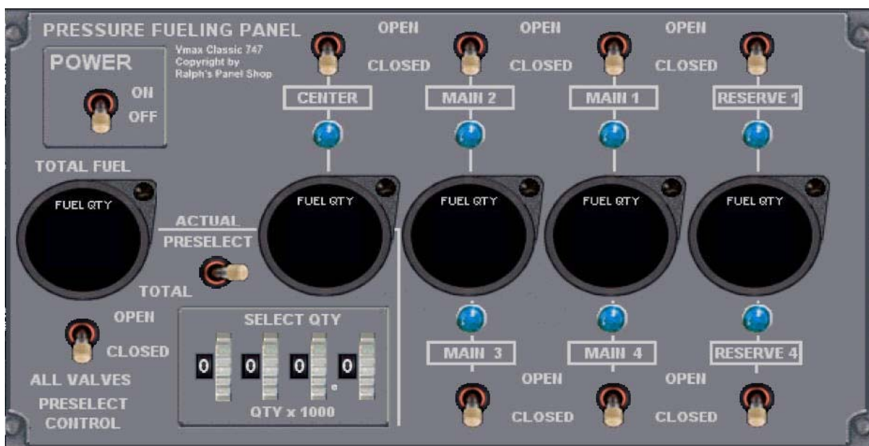
Figure 32 : panneau de remplissage carburant
