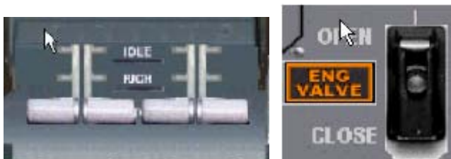
Figure 17 : Commande des vannes de réacteur
