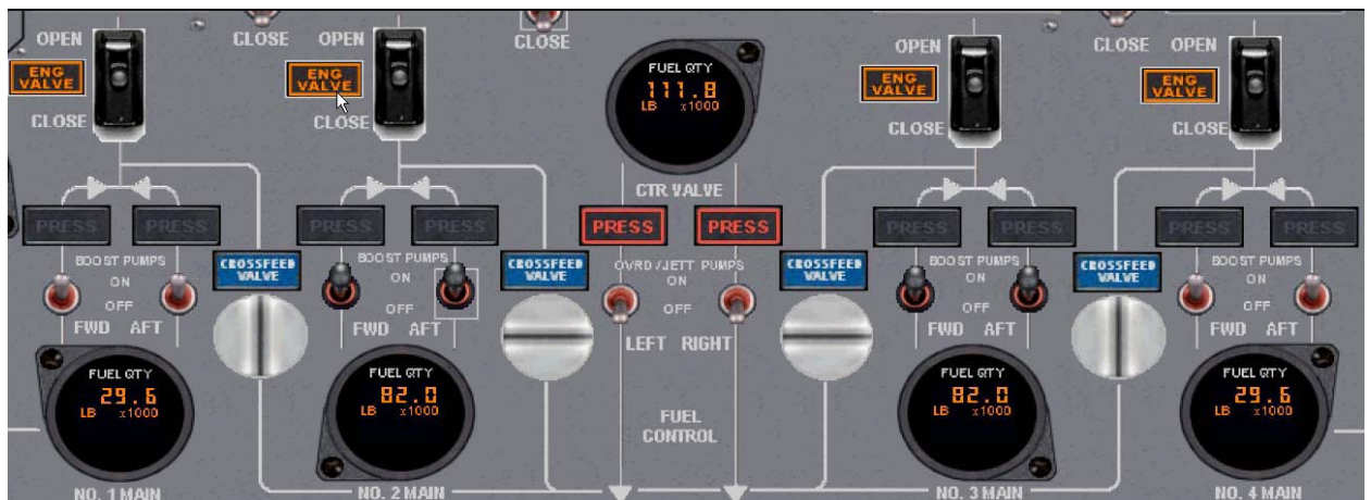
Figure 27 : Roulage et décollage, avec moins de 10 000 lbs dans le réservoir principal
