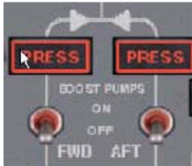
Figure 6 : Interrupteurs des pompes des réservoirs principaux
