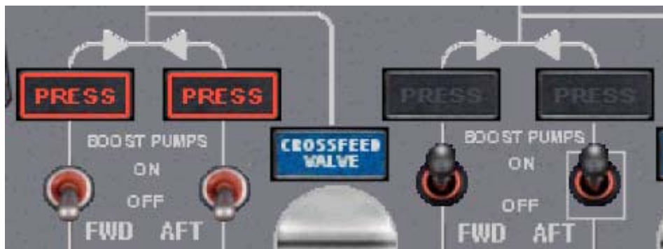
Figure 24 : Interrupteurs de pompes de gavage
