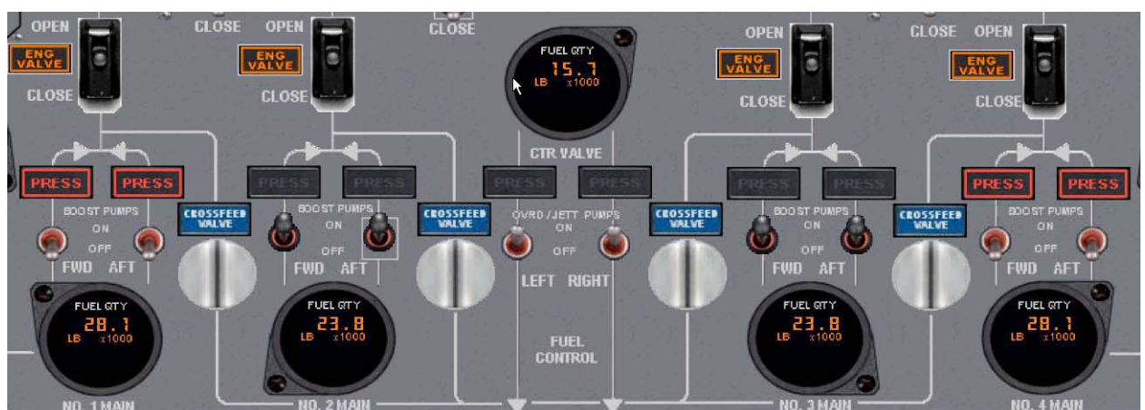
Figure 29 : Montée et croisière, avec plus de 10 000 lbs dans le réservoir principal
