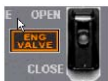
Figure 8 : Vannes de coupure des moteurs
