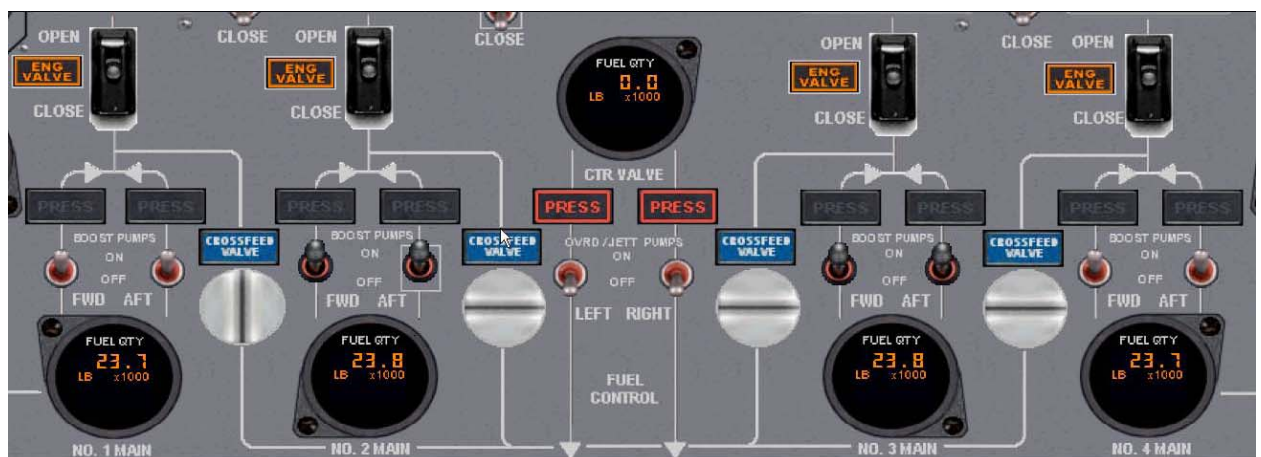
Figure 31 : Montée et croisière, réservoir central vide, réservoirs n°2 et n°3 égaux aux n°1 et n°4 plus leurs réserves
