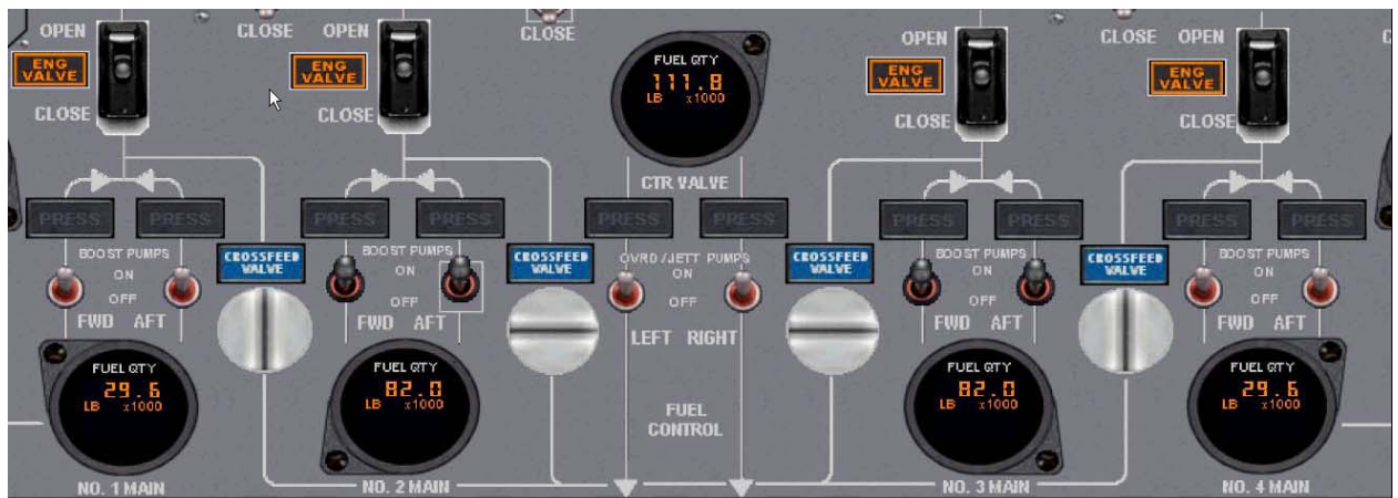
Figure 28 : Roulage et décollage, avec plus de 10 000 lbs dans le réservoir principal
