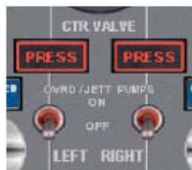
Figure 7 : Interrupteurs des pompes de réservoir central
