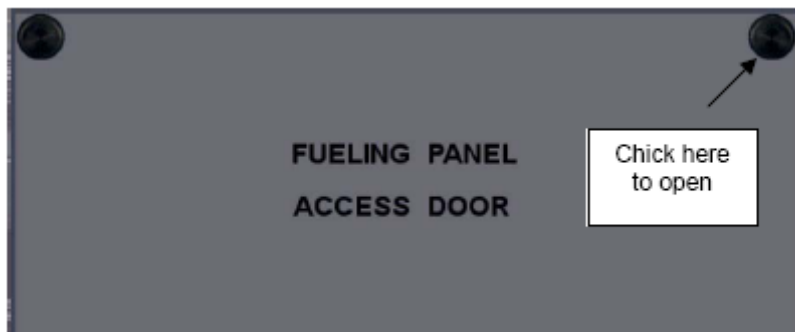
Figure 3 : Panneau de fuel, ouverture
